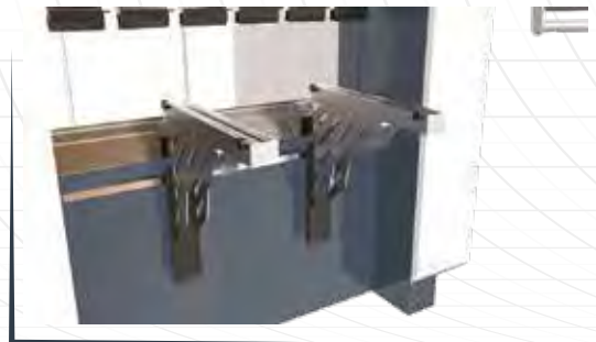
Vordere Blechauflagearmsystem mit Aluminium Gehung und Linearführung
