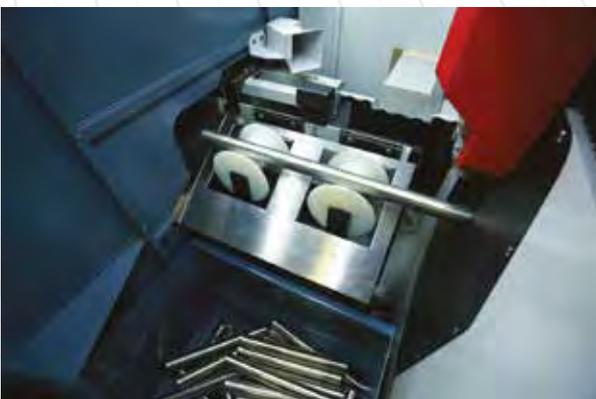
Wenn die Länge der geschnittenen Rohre und Profile weniger als 800 mm beträgt, werden die kleinen Reststücke in den Sammelbehälter abgelegt.
