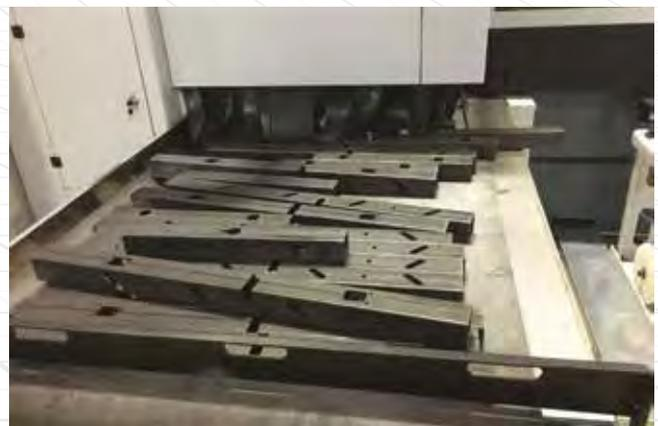
Das automatische Fördersystem übernimmt jedes Rohr und Profil bis zu 6 m Länge und führt es nach draußen..
