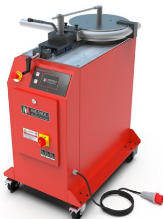
Mit Biegevorrichtung AB-CT zum Rohrbiegen ohne Dorn
