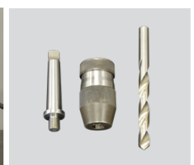
Adapter MT2 x 1/2" 20 UNF, Schnellwechsel-Bohrfutter 1/2" 20 UNF Spiralbohrer bis zu \Phi 16.0 mm (DIN 338)
