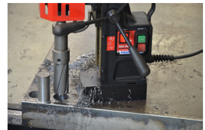
Maximale Fräskapazität bis zu 55 mm Maximale Schnitttiefe bis zu 75 mm
