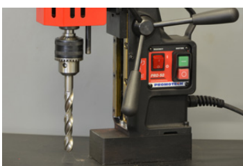
Adapter MT2 x 1/2" 20 UNF, Bohrfutter 1/2" 20 UNF Spiralbohrer bis zu \Phi 16.0 mm (DIN 338)
