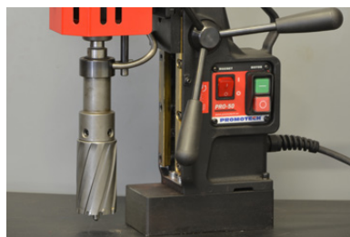
TCT-Fräser bis zu \Phi 50 mm mit Dorn AMT2-C19/2-3 für 75 mm Schnitttiefe
