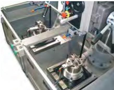
Detailansicht selbstzentrierender hydraulischer
