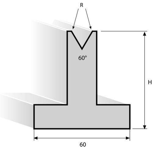
Utensili per presse piegatrici realizzati con standards di qualità superiore, temprati a induzione sulle parti di lavoro e totalmente rettificati. Lunghezza standard: 835 mm; 415 mm; 835 frazionati.
