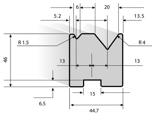
Utensili per presse piegatrici realizzati con standards di qualità superiore, temprati a induzione sulle parti di lavoro e totalmente rettificati. Lunghezza standard: 835 mm; 415 mm; 835 frazionati.
