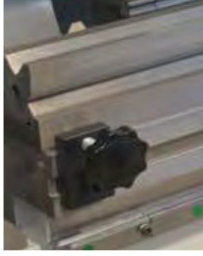
Kolay Ayarlanan Alt Kalıp Taşıyıcı Yatak Easy Adjustment And Fixing On Lower Die Bed
