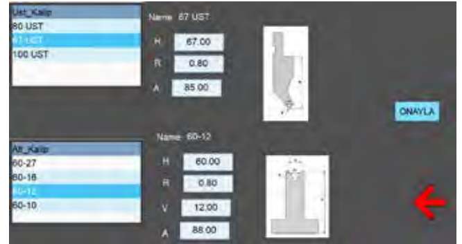
Kalıp Seçim ve Oluşturma Özelliği Selection and Drawing Tooling Feature on Controller
