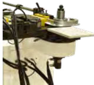
Hidrolik Kalıp Sıkma Hydraulic Tooling Clamp
