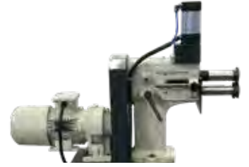
Pnömatik Baskı Pneumatic Top Shaft
