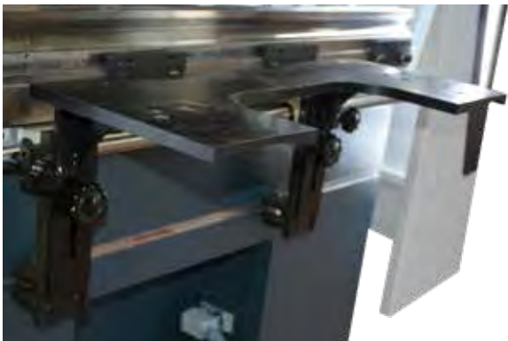
Ön Destekte Ayrı Ayrı Yükseklik ayarı Seperate Height set on Front support
