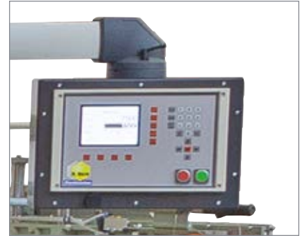
5,7" FARB-TFT TOUCH-SCREEN-BILDSCHIRM SPEICHERT BIS ZU 99 PROGRAMME, 6.000 DATENSÄTZE
