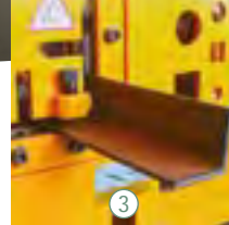
Köşebent kesme istasyonu Angle cutting station
