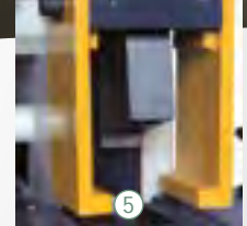
U çentik açma istasyonu U-notching station
