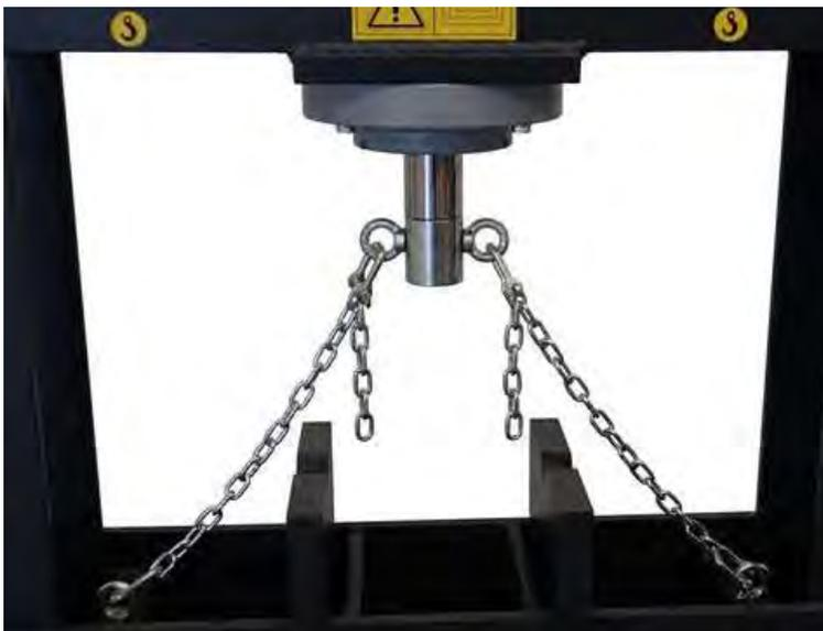
Das **Anheben der Arbeitsbühne** erfolgt über eine **Kette**, die mit dem Hydraulikzylinder verbunden ist.
