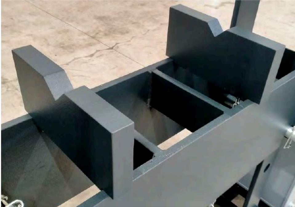
Das V-Prismenpaar dient zur **Auflage** des zu bearbeitenden Metallstücks und wird an der Arbeitsfläche der Hydraulikpresse befestigt.
