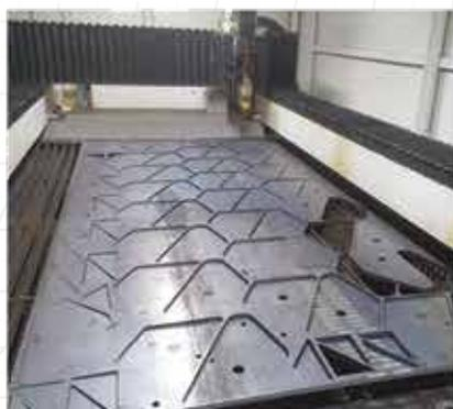
Blechzuschneidzentren für Auftragsfertigung
