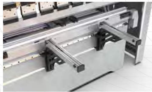
Vordere Blechauflagearmsystem mit Aluminium Gehung und Linearführung
