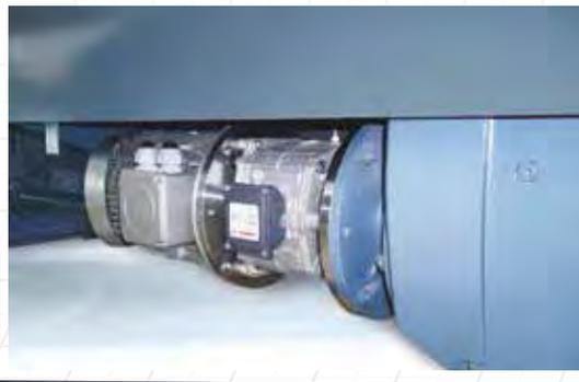
DURMA Magnetbremse und Kupplungssystem ist zum Starten, Stoppen, Positionieren, Steuern und Regeln der Bedingungen.
