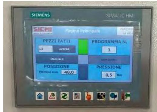
Auf Wunsch kann das **Touchscreen-Display Siemens KTP 700 Basic** installiert werden, mit dem Sie die folgenden Parameter einstellen können:
