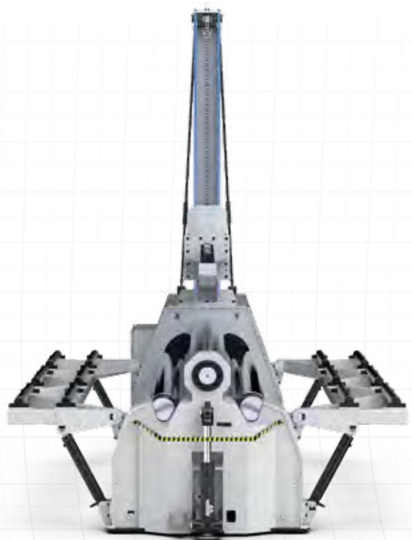
Von den Standard Blechstützsystemen, kann in das Doppelseitenausstützsystem eingegriffen werden und wenn die Größen dieser Stützen auf den Anspruch der Kunden hergestellt werden, wird eine Präzise und hervorragende Biegung gewährleistet.
