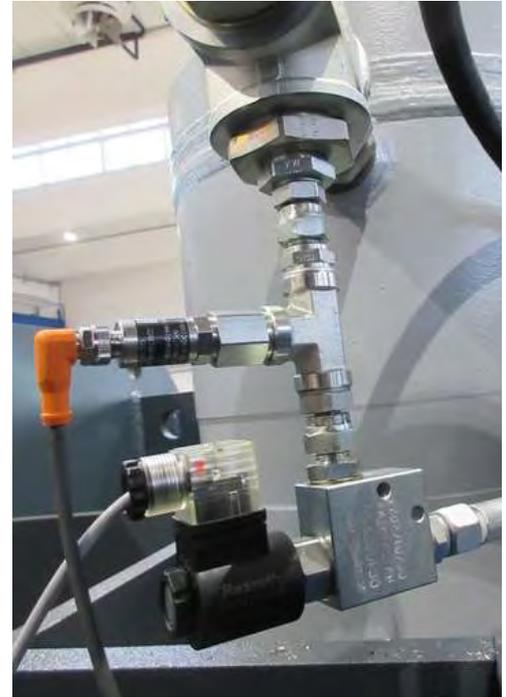
Im Wesentlichen schützt dieses Zubehör den Hydraulikkreislauf der Presse und wird besonders beim Arbeiten mit hohem Druck empfohlen.
