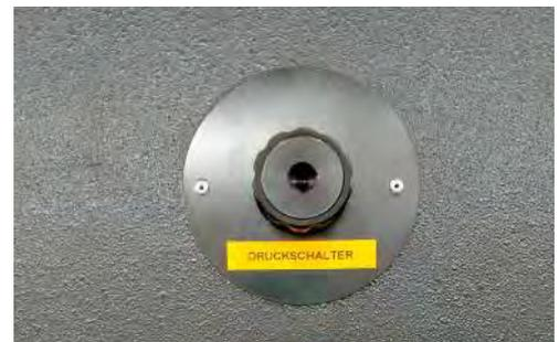
In der automatischen Version der Pressen ermöglicht es, dass der Hydraulikzylinder **automatisch angehoben** wird, wenn der Kalibrierdruck erreicht ist.
