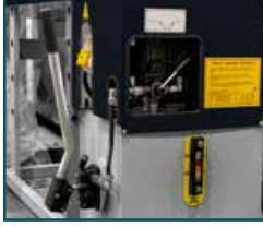
El Pompası (100 TON için geçerlidir) Hand Pump (Valid for 100 TON)
