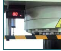
Dijital Kurs Göstergesi Digital Stroke Read out
