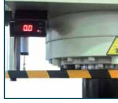
Dijital Kurs Göstergesi Digital Stroke Read out
