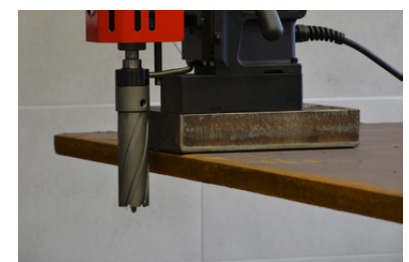
Startpunkt der Bohrung bis zu 50 mm unter dem Niveau des Bohrsockels mit 100 mm langem Fräse
