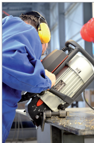
Fasen von Blechen
