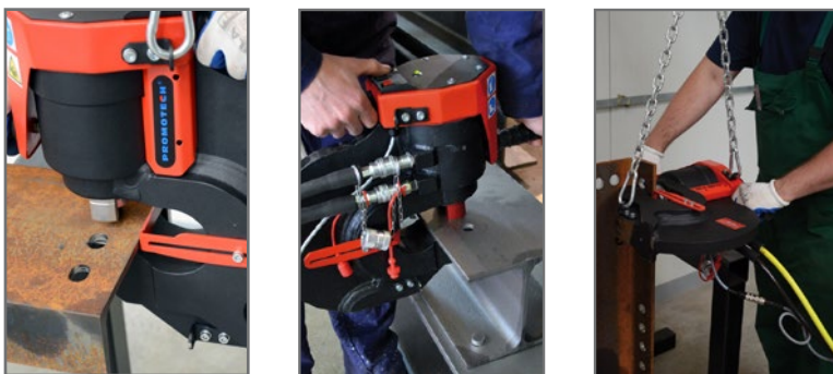
Arbeiten in vertikaler und horizontaler Position
