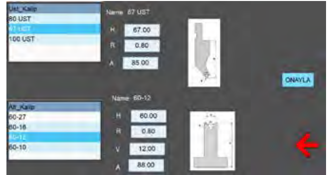
Kalip Seçim ve Oluşturma Özelliği Selection and Drawing Tooling Feature on Controller
