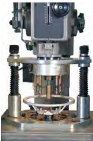
Detailansicht der Bohrbearbeitung von Fahrzeuglenkkrads mit einem Mehrspindelbohrkopf.
