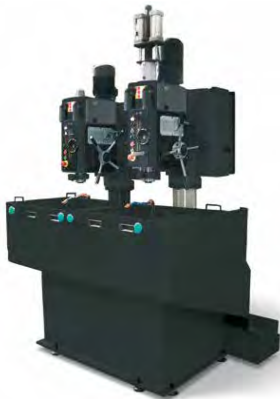
2-teilige Reihenbohrmaschine (Bohren und Gewindeschneiden) mit Leitspindel für Kugelgelenke in der Automobilindustrie.
