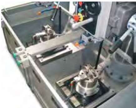
Detailansicht selbstzentrierender hydraulischer Spannwerkzeuge für Kugelgelenke in der Automobilindustrie.
