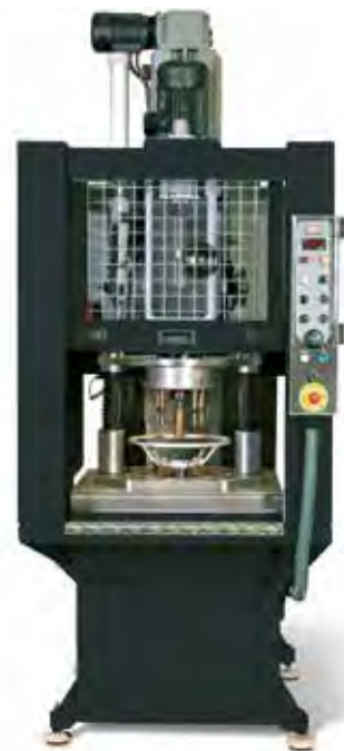
Bohreinheit mit Mehrspindelkopf zum Bearbeiten eines Fahrzeuglenkkrads nach strengen technischen Sicherheitsvorschriften des Kunden.
