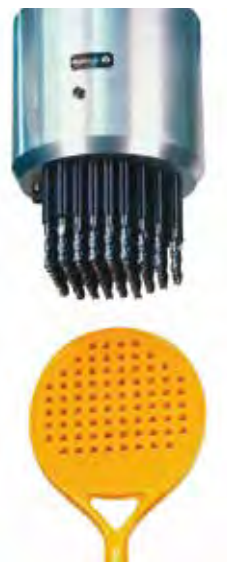
Anwendung des gleichzeitigen Bohrens von 76 Löchern in einen Paddelschläger.
