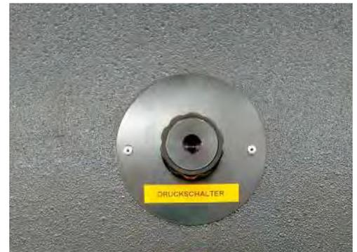
Der Druckschalter ermöglicht ein **automatisches Anheben des Hydraulikzylinders** bei Erreichen des eingestellten Drucks.
