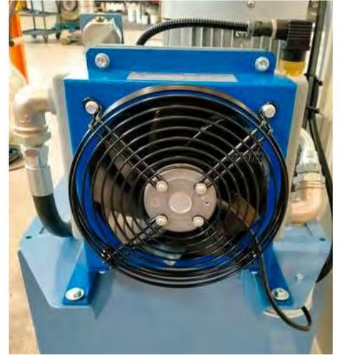
Seine Installation macht es besonders nützlich, wenn die Maschine für lange **Produktionszyklen oder in sehr heißen Umgebungen arbeiten muss**.
