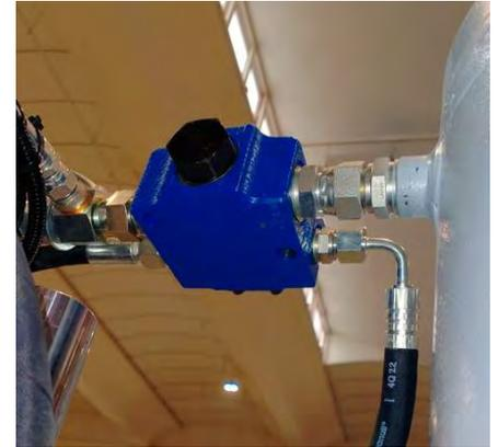
Das Druckblockventil ist oben am Zylinder installiert und wirkt wie ein Wasserhahn. Tatsächlich hat es die Funktion, zu verhindern, dass kleine Öllecks langsam aus dem Zylinder austreten und in den Hydraulikkreislauf zurückkehren, was zu einem fortschreitenden Druckabfall führt.
