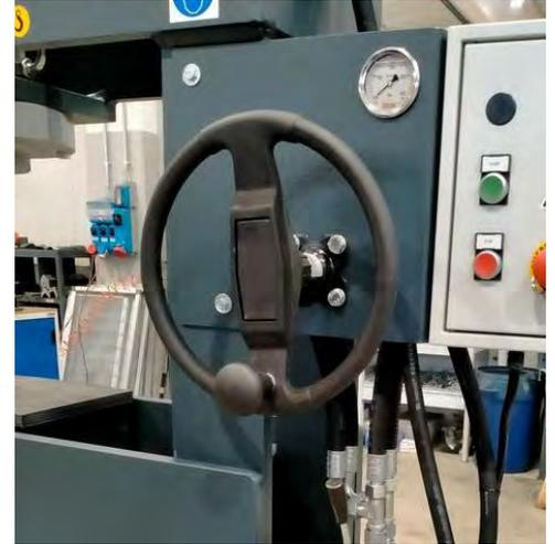
Der Zylinderhub beträgt **350 mm** und übt einen maximalen Druck von 270 bar aus. Da die Annäherungsgeschwindigkeit des Zylinders **10 mm/s oder weniger** beträgt, kann der Bediener die elektrohydraulische Presse nur mit einer Hand bedienen.
