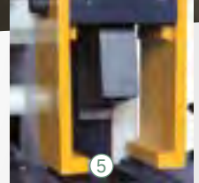
5 U çentik açma istasyonu U-notching station
