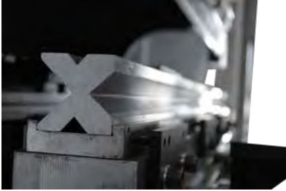
Kolay Ayarlanan Alt Kalıp Taşıyıcı Yatak Easy Adjustment And Fixing On Lower Die Bed
