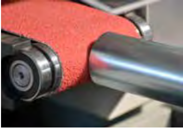
Basit Merkezleme Ayarı Basic Centralizing Adjustment
