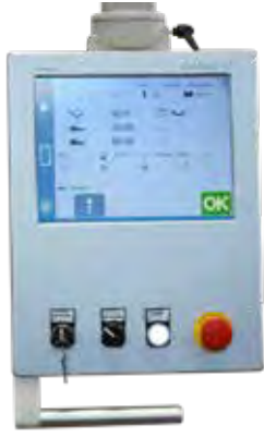
Cybelec-Cybtouch 12 CNC Kontrol Ünitesi Cybelec-Cybtouch 12 CNC Controller
