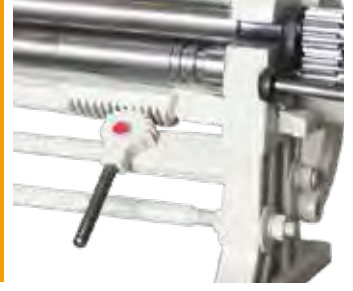
Kolay Alt top Sıkıştırma Kolu Easy Bottom Roll Pinching
