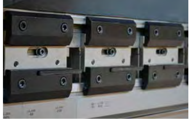
Promecam Bıçak Bağlantısı Promecam Blade Installed
