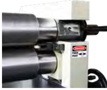
Standart Konik Kıvrım Makarası Standard Conical Bending Device
