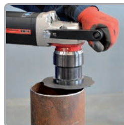
Anfasen von Rohren
