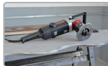
Gewölbtes Anfasen von Kanten mit Radius
