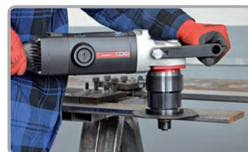
Anfasen von Stahlblechen
