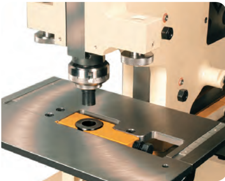
4 Matrizenhalter Schwanenhals zum Stanzen von Flachstahl und Formstahl. Schnellspaneinrichtung.
