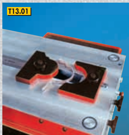
T13.01 Stampo per supporto grondaie • Gutter support die • Moule pour support de gouttière • Dachrinnenhalterstanze • Molde para soportar canalones
