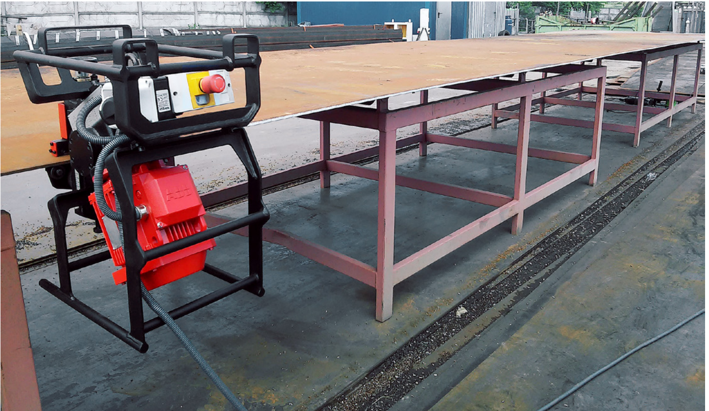
ABM-14 läuft automatisch an der Platte entlang
