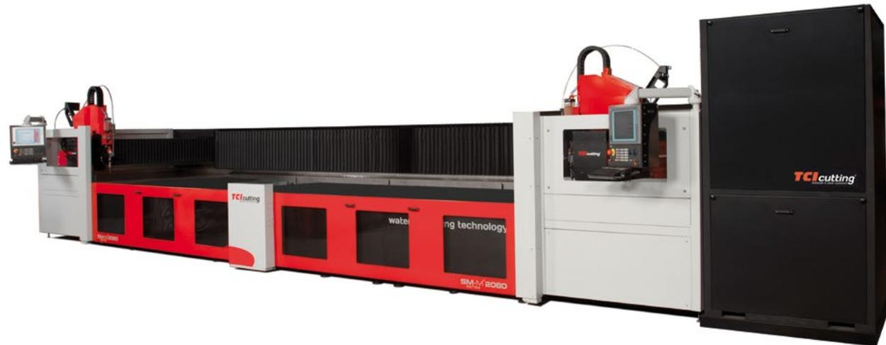
Die Schneidanlagen der SM-M Serie ermöglichen sowohl die Installation eines zweiten unabhängigen Schneidtischs als auch die Verlängerung des Hauptschneidtischs, wodurch die Leistung maximiert wird.
