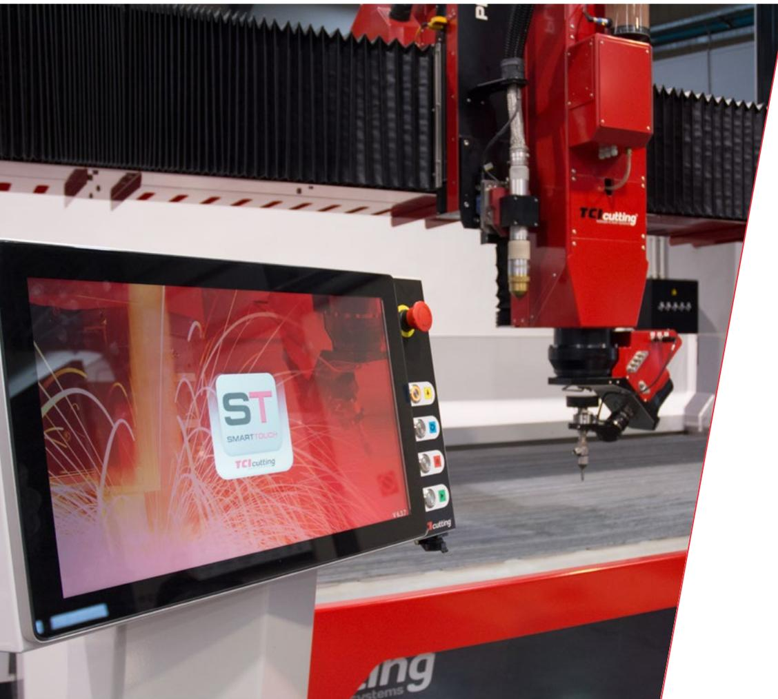
Eine neue und sehr intuitive Mensch-Maschine-Schnittstelle, die alle Funktionen bietet, um die Maschine zu bedienen. Es beinhaltet die Möglichkeit Schnittparameter zu programmieren und zu ändern, die ständige Kontrolle des Extraktionssystems, die Anzeige des Verbrauchsmanagements, usw.
