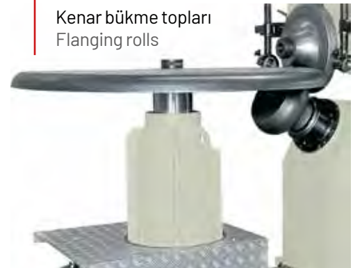
Maks-50mm , Min-10mm Flanş Yüksekliği Max-50mm , Min-10mm Flange Height
