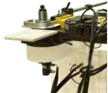
Hidrolik Kalıp Sıkma Hydraulic Tooling Clamp
