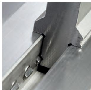
Durch das V-Lock® Prinzip wird das Einspannen und Positionieren der Unterwerkzeuge optimiert. Eine Nut an der Rückseite des Werkzeugträgers dient zum automatischen Ausrichten von Unterwerkzeugen entlang der X- und Y-Achse und zum festen Einspannen. Alle New Standard Bombiersysteme und Unterwerkzeughalter mit hydraulischem Klemmsystem sind mit dem V-Lock® System ausgestattet.
