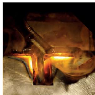
Fast alle Abkantwerkzeuge von WILA sind CNC-Tiefgehärtet®. Dasselbe gilt für die New Standard Premium-Werkzeughalter von WILA. Dies macht sie extrem robust und langlebig. Unsere New Standard Premium Werkzeughalter werden wie hier dargestellt gehärtet.
