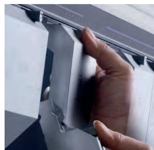
Der Safety-Click® ist WILA's patentierter Sicherheitsmechanismus, der in Oberwerkzeuge mit einem Gewicht bis 12,5 Kg integriert wurde. Dieser revolutionäre Mechanismus erlaubt den sicheren und schnellen senkrechten Werkzeugwechsel durch einfaches Ein- und Ausklicken aus dem Werkzeughalter.
