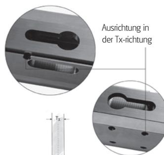
Die Tx-Ausrichtung wird benötigt, um die Position der Biegelinie (Mittellinie) der Werkzeuge in Relation zum Hinteranschlag der Abkantpresse mit extrem hoher Präzision einzustellen. Idealerweise ist diese Funktion in jedem Werkzeughalter vorhanden.
