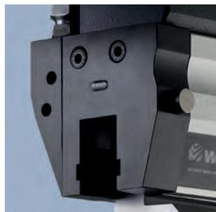
Spezielle Guards für WILA's E2M®-System. Diese Guards haben einen E2M® Sicherheitsmechanismus, der dafür sorgt, dass die Werkzeuge erst aus dem Werkzeughalter entfernt werden können, wenn der Bediener sie freigibt.
