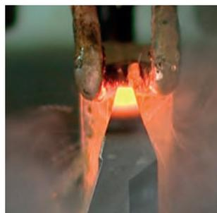
Fast alle Abkantwerkzeuge von WILA sind CNC-Tiefgehärtet®. Dasselbe gilt für die New Standard Premium-Werkzeughalter von WILA. Dies macht sie extrem robust und langlebig. Unsere New Standard Premium- und American Style- Ober- und Unterwerkzeuge werden wie hier dargestellt gehärtet.
