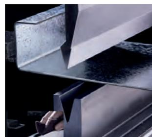
'Biegen statt reinigen!' OZU-ZN Unterwerkzeuge sind mit einer Beschichtung versehen, die WILA extra für das Biegen von galvanisiertem Stahl entwickelt hat. Diese Beschichtung wird auf CNC-Tiefgehärtete®-Unterwerkzeuge aufgetragen und verhindert Zinkablagerungen auf den Biegeradien.
