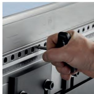
Wenn Unterwerkzeuge nicht so oft gewechselt werden müssen, kommen New Standard Premium und Pro Crowning und Unterwerkzeugträger auch mit einem manuellen Klemmsystem aus. Die manuelle Klemmung wird durch Klemmbolzen in einem Abstand von 25 mm in der Mitte 1000 mm und 100 mm an jedem Ende erreicht. Dadurch können Werkzeugsegmente ab 15 mm Länge gespannt werden.
