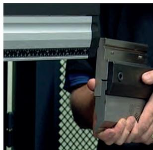
Zwischenstücke werden zwischen dem oberen Werkzeughalter und dem Oberwerkzeug eingesetzt. Sie werden häufig zum Verlängern der Oberwerkzeuge verwendet, damit tiefe Kästen gebogen werden können. Diese Zwischenstücke sind in den Längen 150 mm und 515 mm erhältlich. Sie werden mit besonders hoher Präzision hergestellt, was ihre Austauschbarkeit garantiert.
