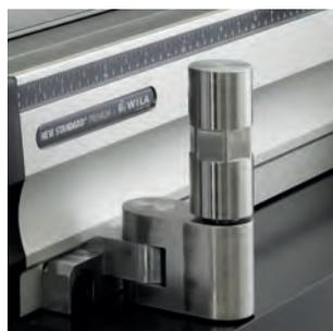
“HD“-Werkzeughalter bieten die Möglichkeit Stützen zu montieren, um sehr breite und schwere Unterwerkzeuge zu stützen. Diese Stützen bieten beim Biegeprozess zusätzliche Stabilität. Sie können mit 255 mm Abstand auf der Vorder- und Rückseite montiert werden.
