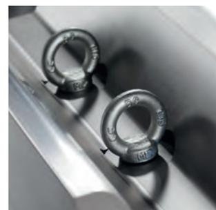
New Standard Typ OZU-HD Unterwerkzeuge und OZU-Unterwerkzeuge > 25 kg sind standardmäßig mit Gewindelöchern für Ringschrauben ausgestattet. Diese Ringschrauben (nicht im Lieferumfang enthalten) erleichtern die Handhabung und den sicheren Wechsel schwerer Unterwerkzeuge.
