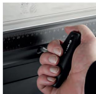
Die Ty-Ausrichtung ist für die Parallelität von Ober- und Unterwerkzeugen unverzichtbar. Die Ausrichtung in Y-Richtung ermöglicht, sämtliche unvermeidliche -kumulierte- Maschinentoleranzen in der Abkantpresse auszugleichen. Wenn man präzise und gleichmäßige Biegeergebnisse erzielen möchte, muss entweder der obere oder untere Werkzeughalter diese Eigenschaft bieten.
