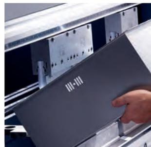
Zwischenstücke werden zwischen dem oberen Werkzeughalter und dem Oberwerkzeug eingesetzt. Sie werden häufig zum Verlängern der Oberwerkzeuge verwendet, damit tiefe Kästen gebogen werden können. Diese Zwischenstücke sind in den Längen 150 mm und 515 mm erhältlich. Sie werden mit besonders hoher Präzision hergestellt, was ihre Austauschbarkeit garantiert.
