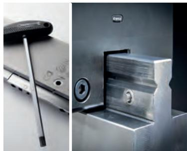
Mithilfe des Lagersystems können schwere Ober- und Unterwerkzeuge schnell und sicher in die Werkzeugträger eingesetzt und entfernt werden. Die Werkzeugträger sollten mit einer Herausfallsicherung ausgestattet sein.
