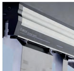
Dieses intelligente Lineal mit LED-Beleuchtung zeigt sofort, wo Werkzeuge im Werkzeughalter platziert werden müssen. Der Smart Tool Locator® ermittelt auch die genaue Biegefolge.
