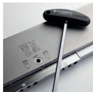
E2M® Unterwerkzeuge sind mit einem internen Hebesystem ausgestattet. Dieses interne Hebesystem ist für ein Werkzeuggewicht von max. 140 kg und einer Werkzeuglänge von mind. 200 mm geeignet. Die Mindestbreite des Werkzeugs sollte 30 mm betragen.
