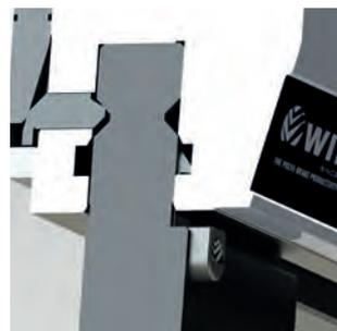
Die Werkzeuge werden mit einem pneumatisch gesteuerten Paar selbstjustierender Keile gespannt. Wenn die Keile eingerastet (geklemmt) sind, werden sie zu einem integralen Bestandteil des Werkzeugs. Das Self-Locking®-Prinzip eignet sich zum Spannen der New Standard Ober- und Unterwerkzeuge (BIU und OZU) von WILA. Die Premium Klemmung wird ebenfalls pneumatisch gelöst.
