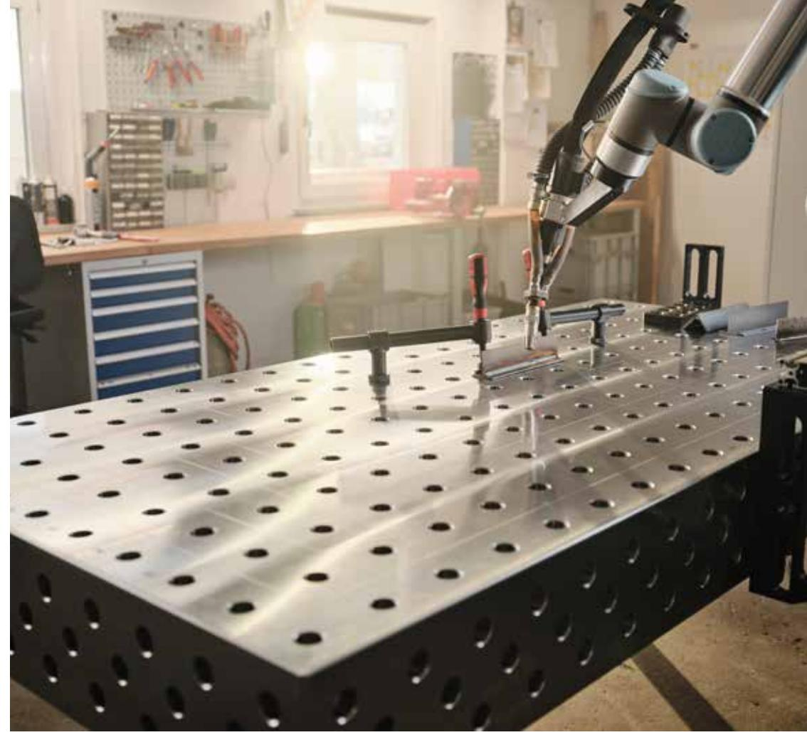
Dieses Modell bildet die Basis des gesamten Systems. Von diesem kann nach allen fünf Seiten beliebig erweitert werden.
