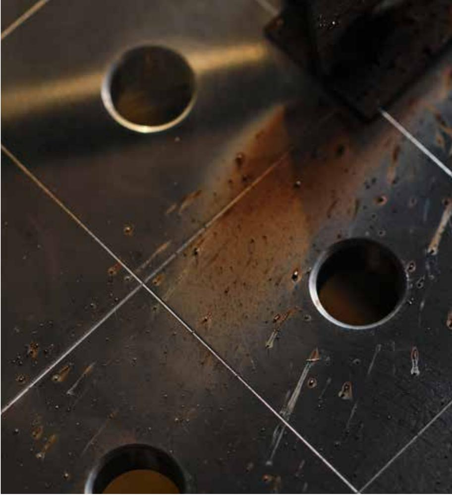
Der wesentliche Vorteil unserer Tische zu herkömmlichen Systemen besteht mit unserer Hartverchromung Cr75 darin, dass dieser Prozess eine wesentlich tiefere Eindringung ins Grundmaterial bis zu 0,07 mm erzielt und die Härte der Oberfläche bis zu HV750 erreicht. Somit ist auch eine optimale und dauerhafte Anti - Spritzerhaftung auf der Oberfläche gewährleistet, welche mitunter zu den leistungsfähigsten am Markt gehört.
