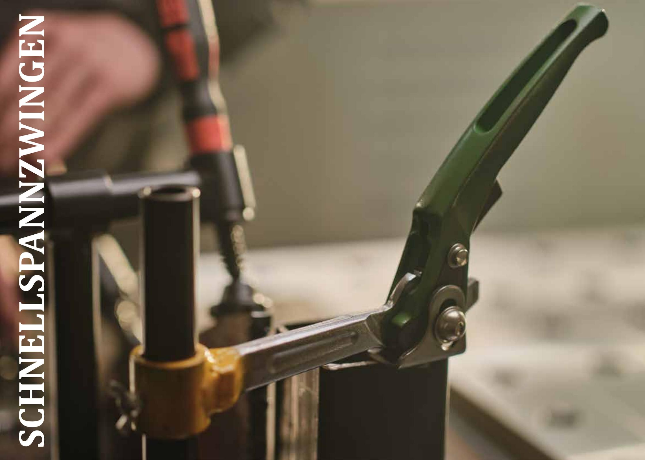
Mit der Rohr-Schnellspannzwinge 180° lassen sich die Werkstücke schnell und kraftvoll spannen. Durch die Rasterung lässt sich die Kraft individuell einstellen. Das vertikale Rundrohr hat eine Länge von 280 mm. Zur Fixierung des Vertikalrohres in den Systembohrungen wird ein Stellring verwendet.
