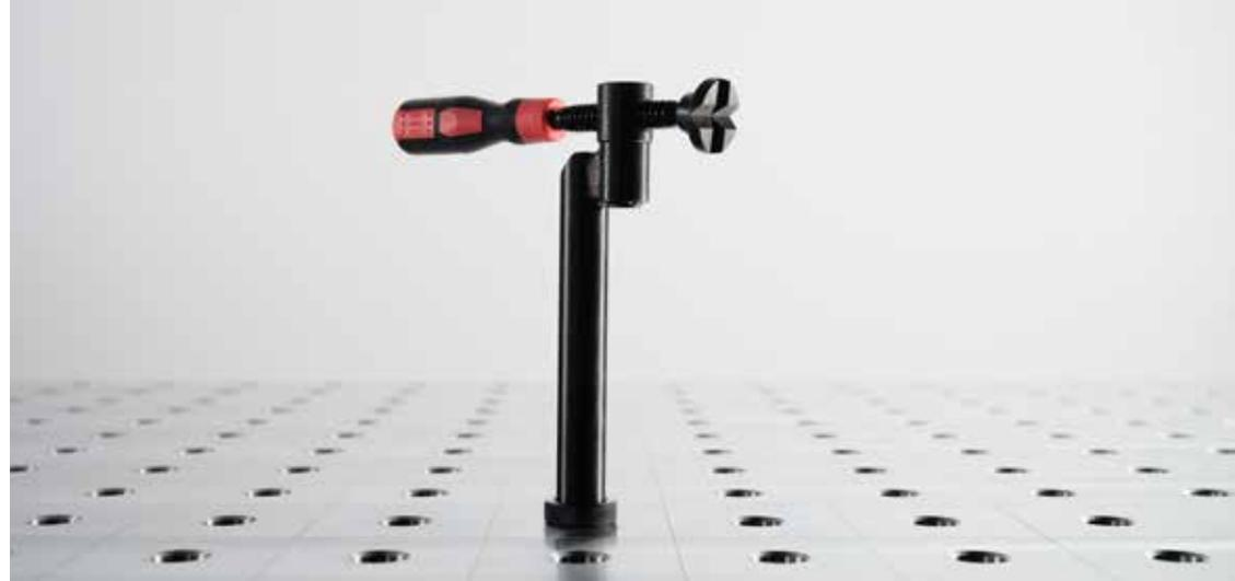
Die Rohrschraubzwinde 90° ermöglicht ein exaktes und kraftvolles Spannen von Bauteilen im 90°-Winkel zur Systembohrung. Die Zwinde ist stufenlos um 360° drehbar und kann somit frei positioniert werden.
