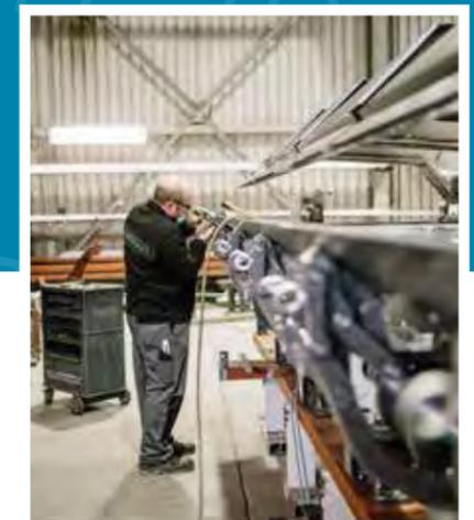
**Die Biegemaschine weitergedacht.** Der Biegemaster BendTron ist die erste Generation, die vollständig mit Elektromotoren arbeitet. Mit dem BendTron biegen Sie in gewohnter Zuverlässigkeit und Präzision alle gängigen Profile von 4 bis 15 Meter Biegelänge mit Materialstärken bis zu 1,5 mm (Stahl 400N/mm<sup>2</sup>).
