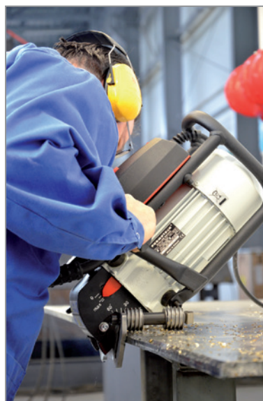
Fasen von Blechen
