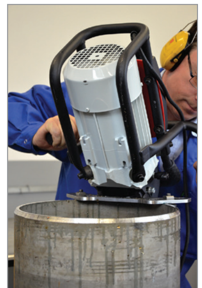
Fasen von Rohren
